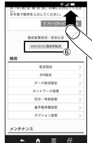
画面を下にスクロールさせ「XHEAD-2 に設定を転送」ボタン⑥をタップしてください。XHEAD-2 が NTP サーバーから日時を取得するまでしばらく待ってから、本体の液晶表示で日時の更新を確認してください。通常は数分以内に日時が更新されます。
