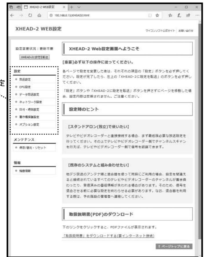
各機能を設定した後は、必ず Web ページ左上にある「設定変更状況」を確認してください。「更新必要」と赤い文字で表示されている場合は、必ず「XHEAD-2 に設定を転送」ボタンをクリックしてください。
