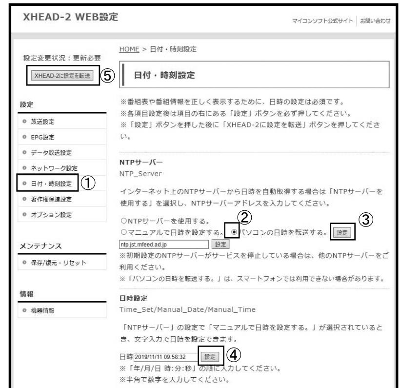
Step2:「日時」の入力欄を確認し、日時が正確であることを確認してください。
