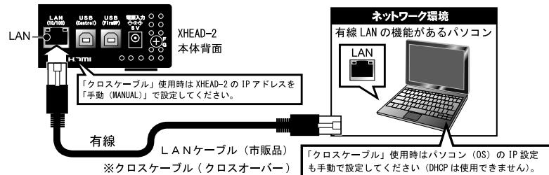
\*パソコンとXHEAD-2を直接接続する際のLANケーブルは「クロスケーブル」を用いてください。
