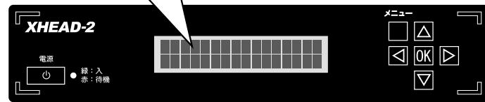
※入力する映像信号の解像度確認は、本体前面の液晶ディスプレイをご確認ください（表示方法は42ページ参照）。メニュー表示以外の時は、入力信号の解像度などを確認できます。
