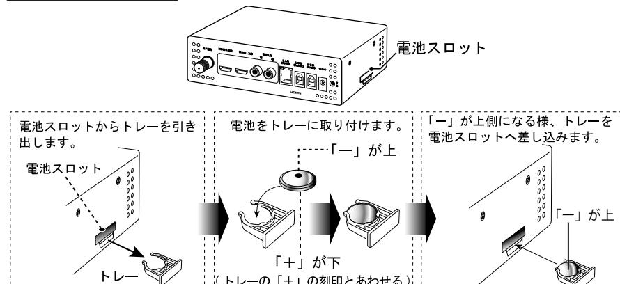
※電池挿入後は、電池が正しく動作している事を確認するため（電池の極性に間違いがないことを確認するため）、XHEAD-2に通電が無い状態で時刻が維持されることを確認してください。
