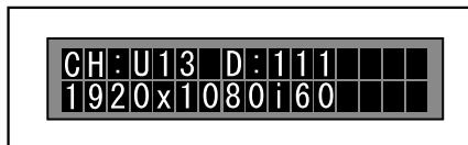
念のため本体の液晶ディスプレイも確認しましょう。入力があれば入力信号の解像度が表示されます。
