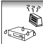
**●結露に注意（部品に水滴が付着すると漏電します）**
