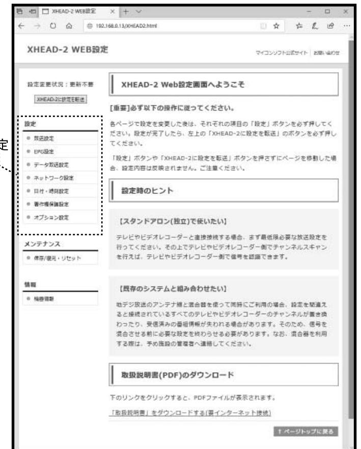
各機能を設定した後は、必ず Web ページ左上にある「設定変更状況」を確認してください。「更新必要」と赤い文字で表示されている場合は、必ず「XHEAD-2 に設定を転送」ボタンをクリックしてください。
