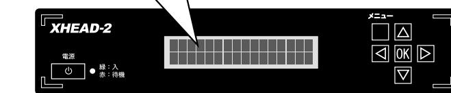
念のため本体の液晶ディスプレイも確認しましょう。入力があれば入力信号の解像度が表示されます。
