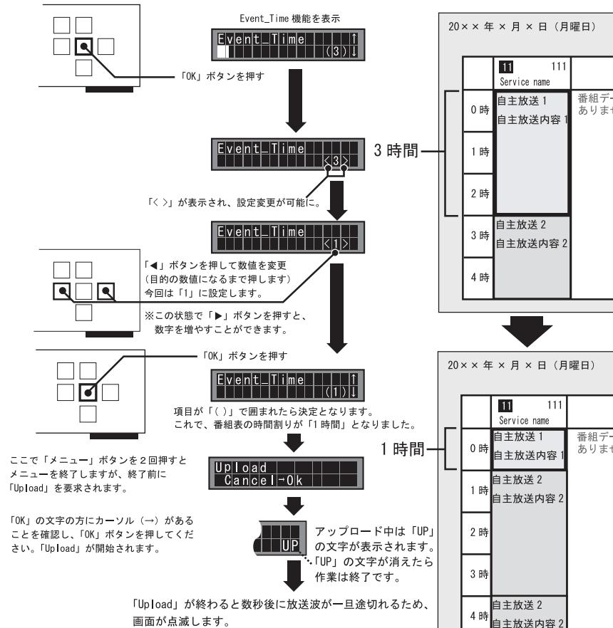
※Upload後の液晶画面の表示は「メニュー終了時に要求されるUploadではメニューが終了します」、「メインメニューのUploadを使用した場合は「UP」は表示されず「Upload」の項目表示に戻ります」。
