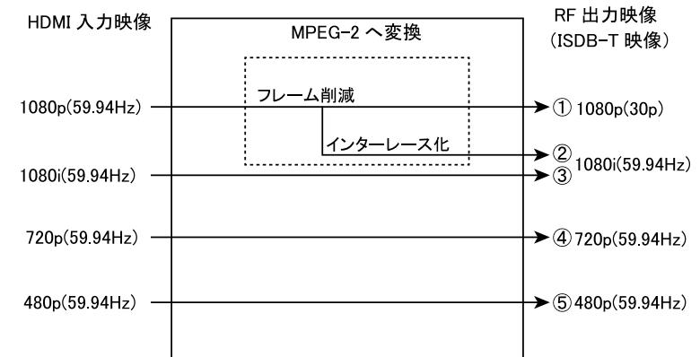
※ ①または②のとき、RF 出力は解像度やフレームレートが変換されますが、HDMI OUT (スルーバー出力) の映像は変換されません。パススルーとなります。
