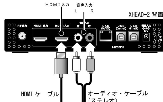
接続が完了したら、XHEAD-2 のメニュー設定「Option\_Menu」 - 「Audio\_Input」の設定を「ANALOG (アナログ)」に変更してください。
