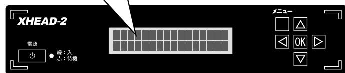
※入力する映像信号の解像度確認は、本体前面の液晶ディスプレイをご確認ください（表示方法は42ページ参照）。メニュー表示以外の時は、入力信号の解像度を確認できます。
