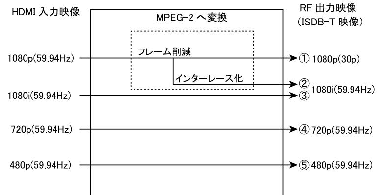
※①または②のとき、RF 出力は解像度やフレームレートが変換されますが、HDMI OUT（スルー出力）の映像は変換されません。パススルーとなります。
